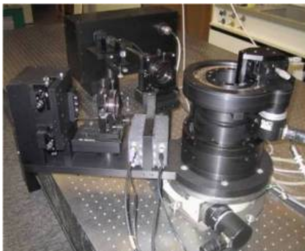
شکل ۶: تصویر شماتیک دستگاه اسپکترومتري 3DDLS
